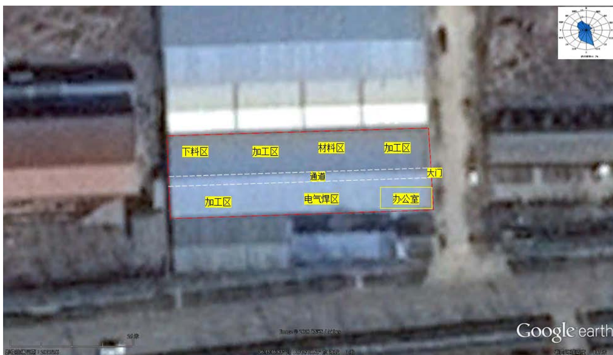
图 3 卫星底片平面布置图
